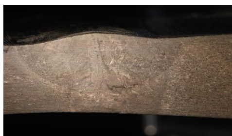
Рис. 1. Макрошлиф сварного шва приварки фланца
